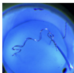
Figure 3e Déplacement d'une boucle le long d'un fil électrique sans contact
